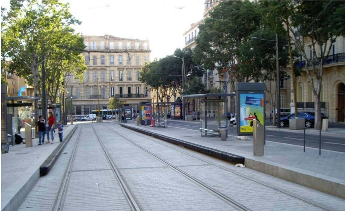
Photo 7: Tramway du Mans (France) – quais latéraux et central avec bus, abris simples
